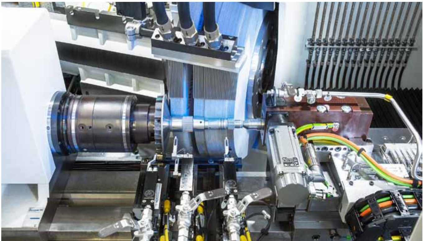
Neu im HG-Baukasten ist eine Schleifspindel für Schleifscheiben mit einem Durchmesser von bis zu 750 Millimetern. Die Maschine bietet somit eine große Schleifscheibe für die Außenbearbeitung und eine kleine CBN-Schleifscheibe zur Nutenbearbeitung.
