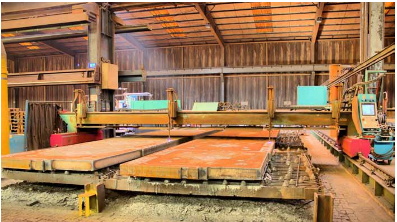
Baujahr 1994 ist die Satronik-HD-8000. Mit einer Breite von 4000 und einer Länge von 8000 Millimetern wird diese Anlage bei von Schaewen zum Schneiden von Teilen bis 250 Millimeter Dicke eingesetzt.
