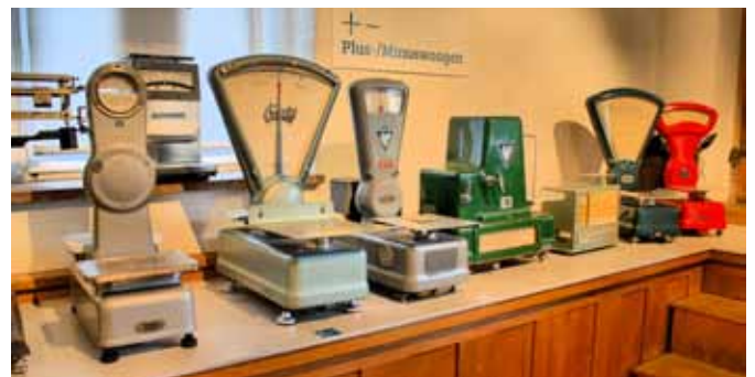
Plus-/Minus-Kontrollwaagen zeigten an, ob das Wiegegut dem auf der Waagenrückseite aufgelegten Gewicht entsprach. Abweichungen nach oben und unten waren sofort ablesbar.
