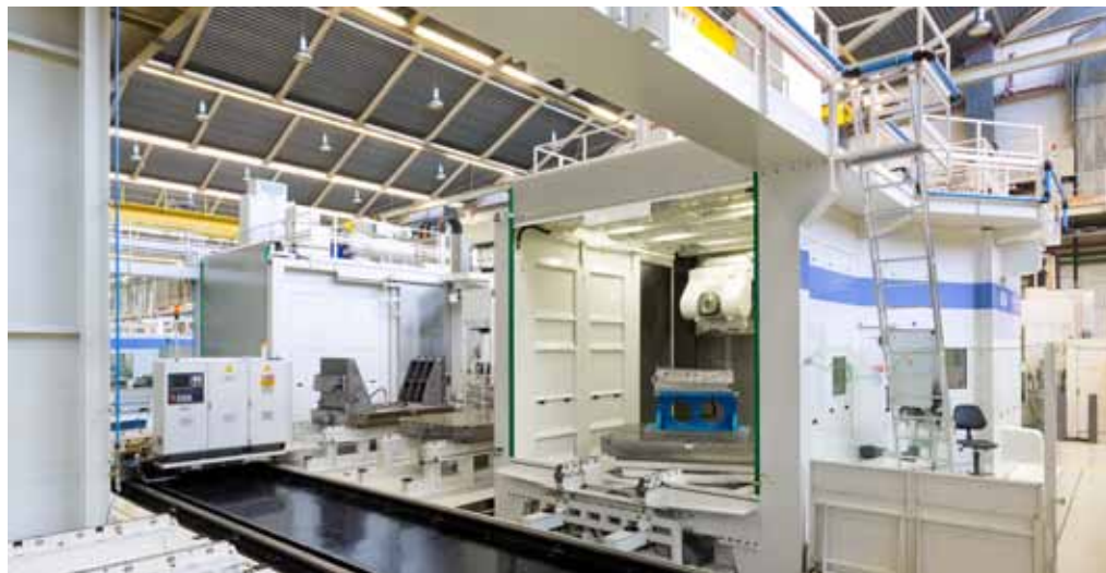
Beim Fräsen der Strukturkomponenten für verschiedene Flugzeuge gilt es, die Titan-Werkstücke in Sekundenschnelle hochpräzise in Position zu bringen.
