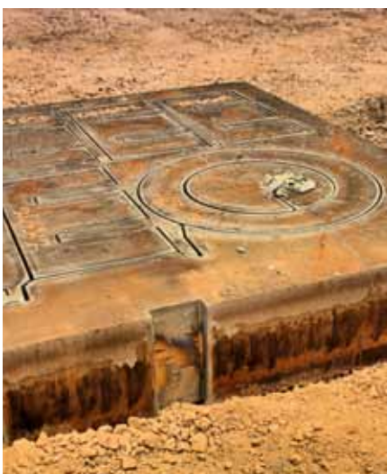
Nachdem Teile aus dem Rohmaterial herausgeschnitten wurden, liegt die Platte zum Auskühlen auf einem Sandbett.
