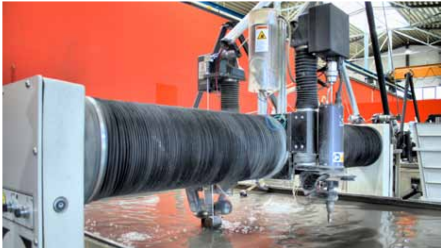
Mehrere Schneidköpfe können an Omax-Anlagen angebaut werden, um ein großes Teilespektrum abzudecken.
