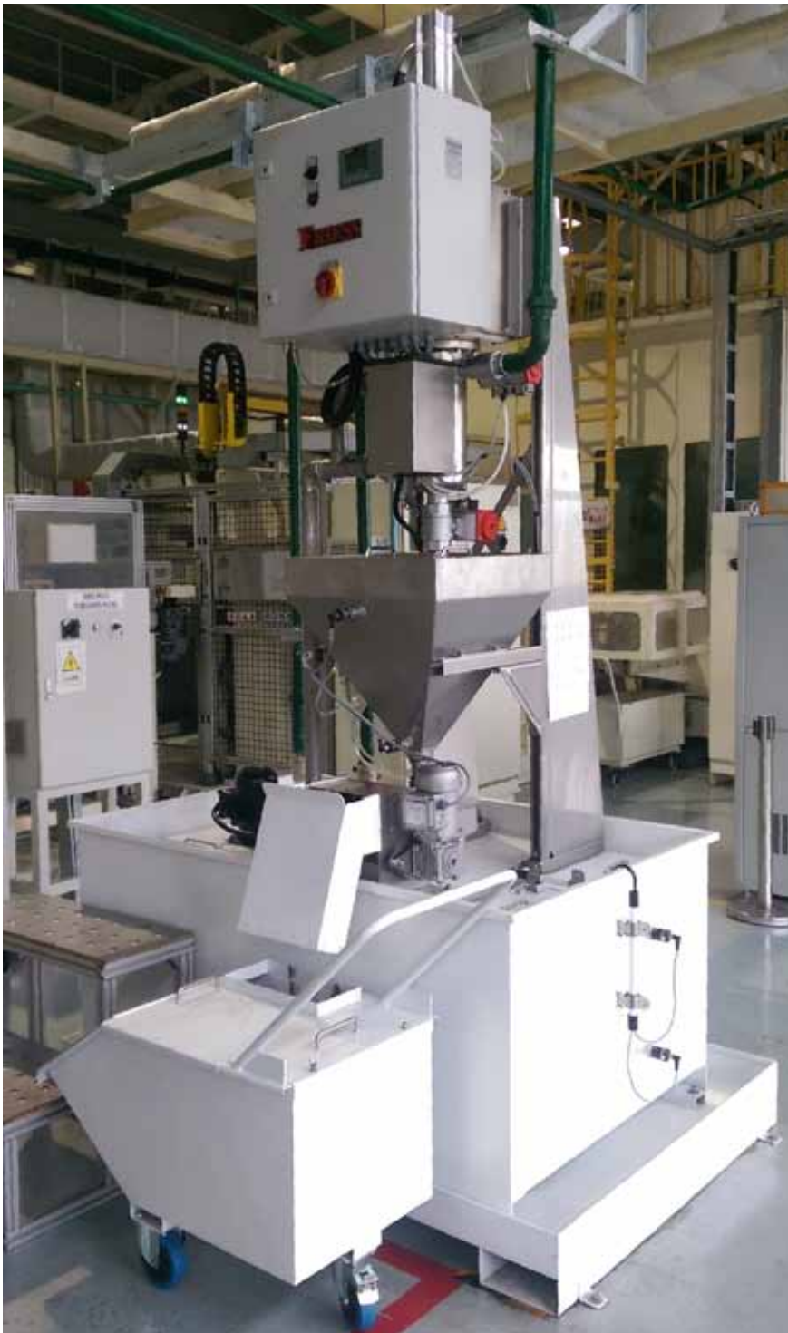
Der automatisch selbstreinigende Magnetfilter ›ASMF 5‹ von Friess besitzt eine Reinigungsanlage für Rückspülflüssigkeit.
