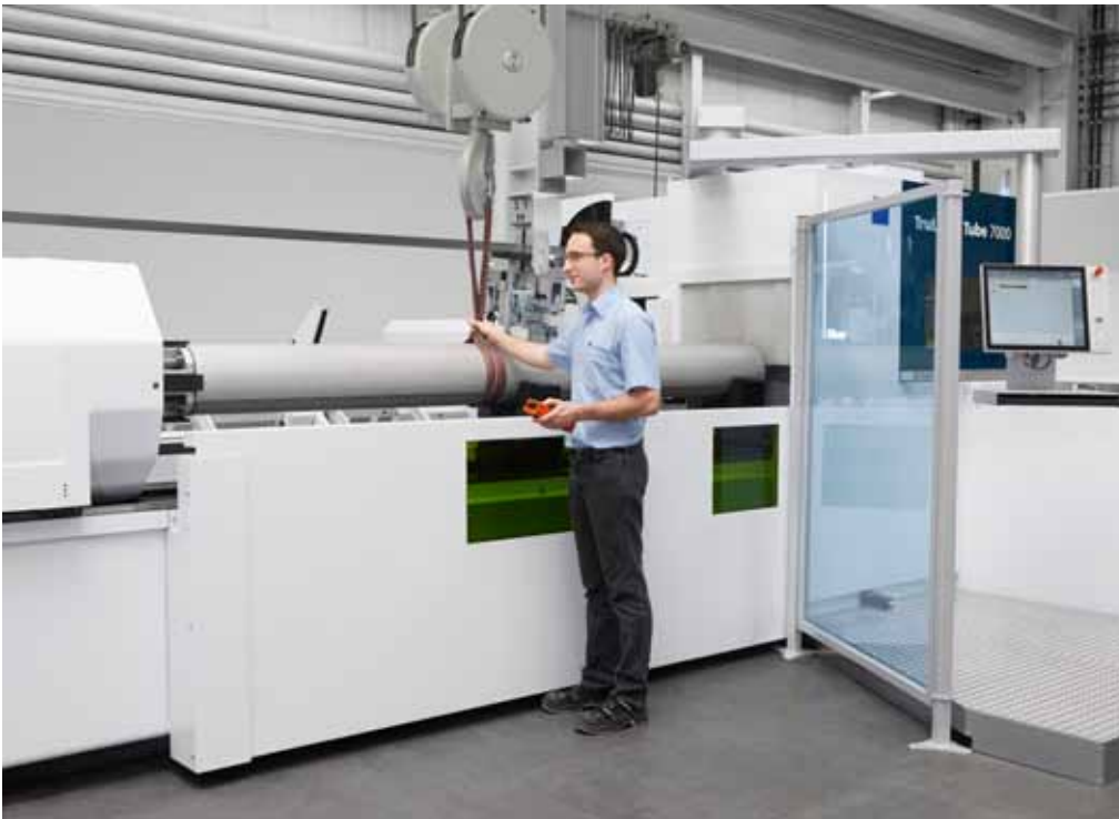
Der durchdachte Strahlschutz der Maschine ermöglicht es, Rohre problemlos mit einem Kran zu beladen.
