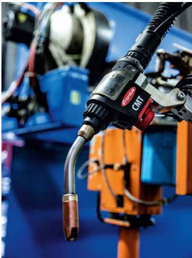
Der Roboterschweißbrenner ›Robacta Drive CMT‹ garantiert höchste Zugänglichkeit und Schweißgeschwindigkeit.
