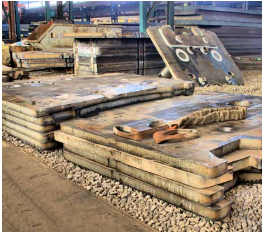
Tariergewichte für Baukräne sind ein Bereich, in dem das Unternehmen von Schaewen zuhause ist. Mit Autogen-Brennschneidanalgen von Sato sind derartige Teile rasch aus Blechplatten ausgeschnitten.
