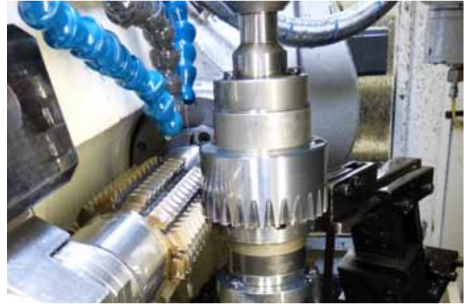
Der Mando G211-Dorn auf der Richardon. Auch hier zeigt sich, dass dieser Dorn optimal zum Abwälzfräsen geeignet ist.
