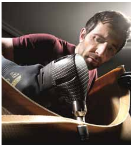
Der Nibbler ›Trutool FCN 250‹ von Trumpf kann Faserverbundwerkstoffe trennen.
