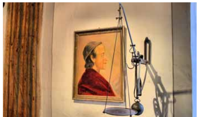
Dem Genie Philipp Matthäus Hahn ist eine Neigungswaage zu verdanken, die auf einer Skala direkt das Gewicht eines Gutes anzeigt. Das Hantieren mit Gewichten wurde damit hinfällig.
