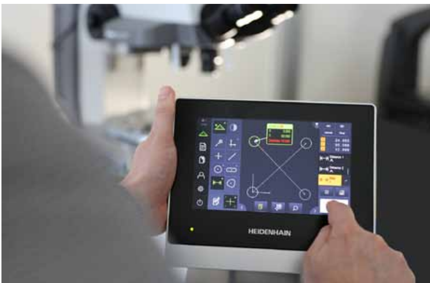
›Quadra-Chek 2000‹ von Heidenhain ist eine Auswerte-Elektronik für 2D-Messaufgaben. Funktionen werden per 7-Zoll-Touchscreen angezeigt und aufgerufen.
