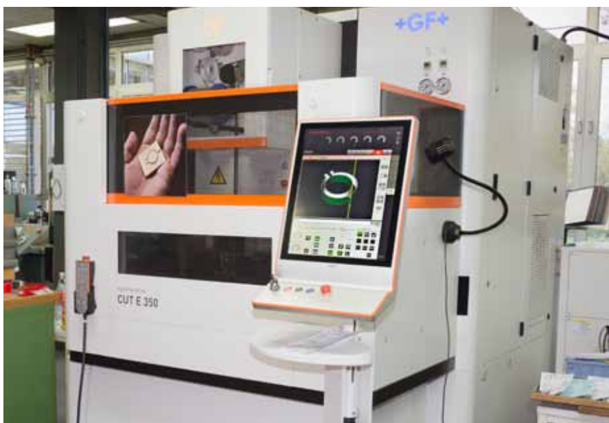
Die Drahterodiermaschine ›AgieCharmilles CUT E 350‹ von GF Machining Solutions erodiert komplexe Formen und benötigt nur wenig Platz.
