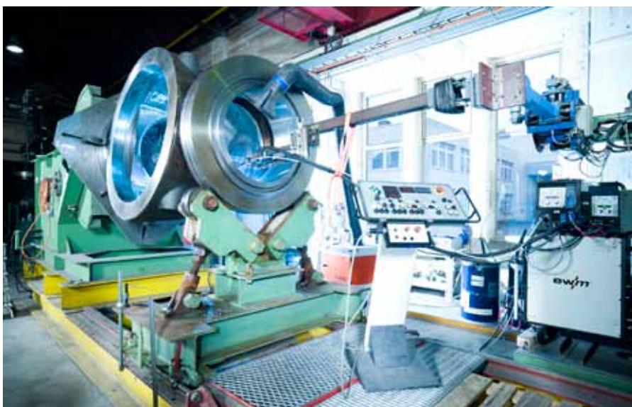
Eine Kugelarmatur eingespannt in die Drehvorrichtung. Rechts die MIG/MAG Schweißstromquelle ›Phoenix 551‹ mit dem Drahtfördersystem ›drive 4X‹ und dem weiteren Drahtvorschubgerät ›tigSpeed drive‹.
