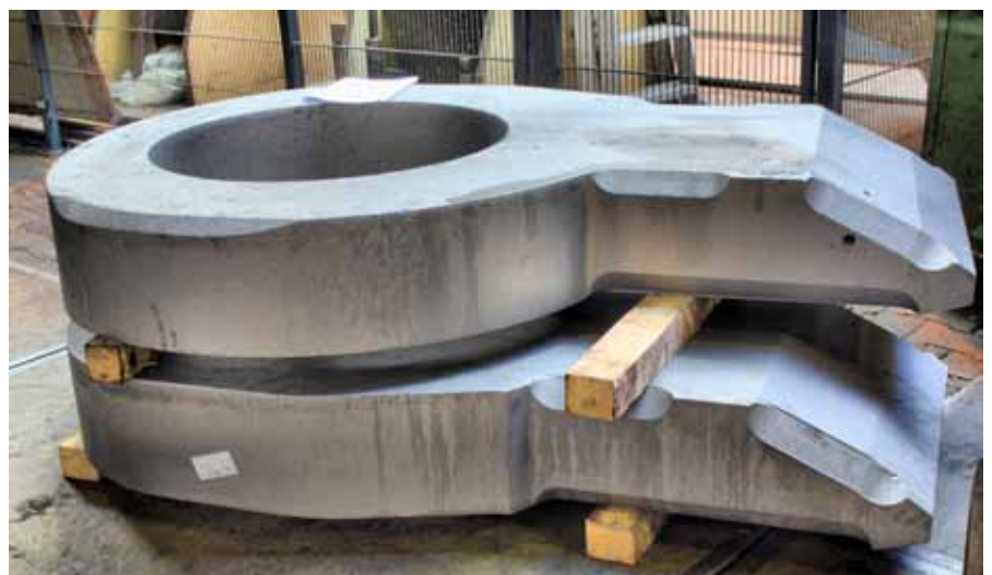
Fasen sind mit schwenkbaren Brennern problemlos einbringbar. Wie die Teile zeigen, ist das Ergebnis sehr präzise. Optionen moderner Sato-Anlagen würden sogar das Kennzeichnen der Teile ermöglichen.
